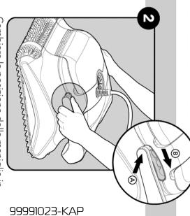
Cambiare la posizione della maniglia in diagonale. Questo determina la velocità con cui il robot avanza lungo la linea di galleggiamento.
