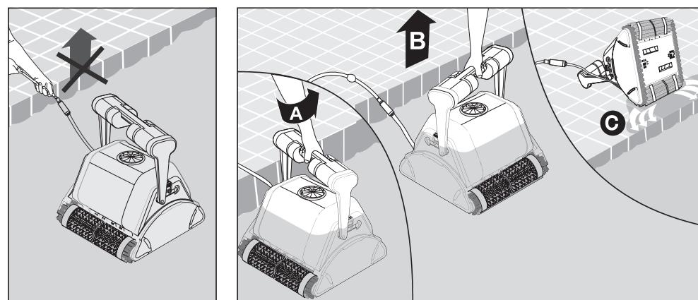
Ziehen Sie den Poolreiniger am Schwimmkabel zum Poolrand.
