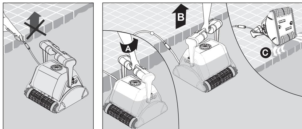
A l'aide du câble de flottaison, ramenez le Nettoyeur de Piscine au bord de la piscine.
