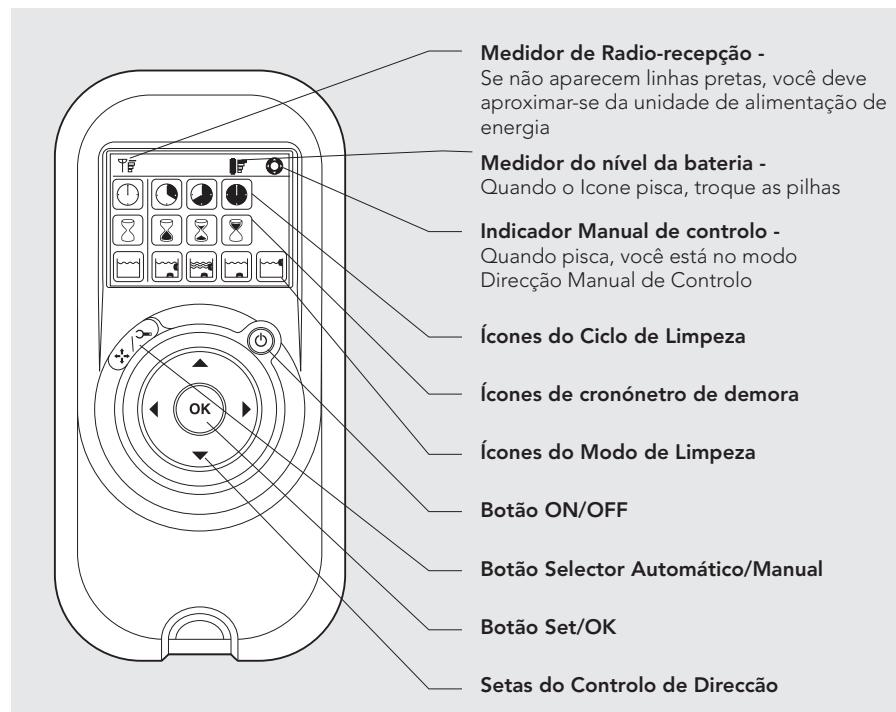
A RCU oferece dois modos de operação – Modo Automático e Modo Manual de Controlo de direcção.
