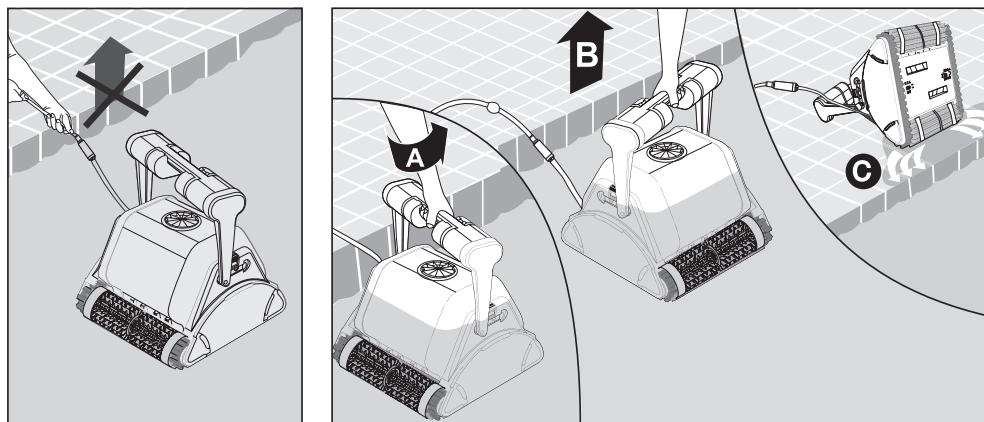
Use el cable flotador para acercar el limpiador hasta el borde de la piscina.
