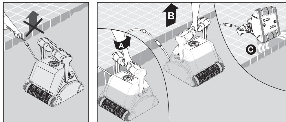
Utilizando o cabo flutuante, traga o aspirador até à borda da piscina.
