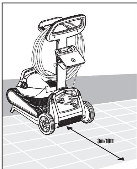
**5.1.1** Posizionare l'alimentazione in modo che sia approssimativamente al centro del lato lungo della piscina, ad una distanza di 3m/10ft.
